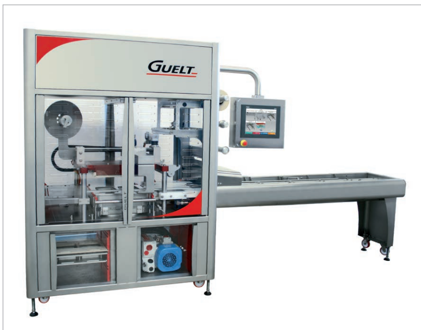
Operculeuse automatique en ligne OPP2000, 100% électrique et connectée. Avec l'aimable accord de la société GUELT, Quimperlé, France
