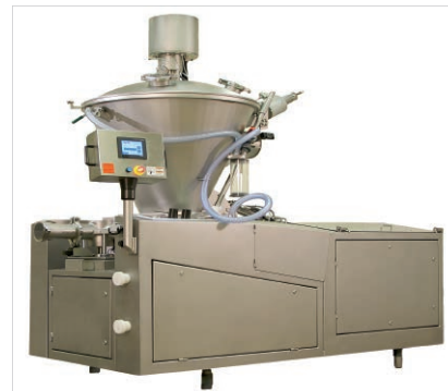
Poussoir à double piston série OPTI - Avec l'aimable accord de la société Marlen International - USA
