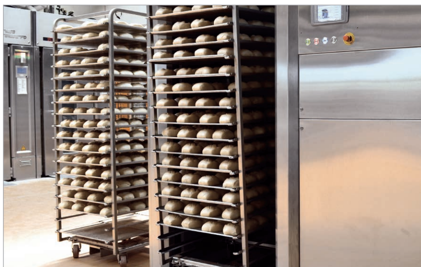
Cellule de refroidissement sous vide pour pains et viennoiseries. Avec l'aimable accord de la société CETRAVAC - Suisse
